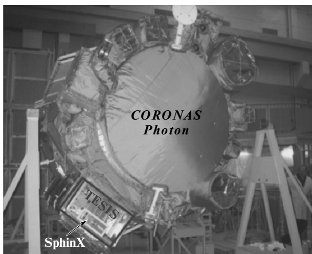
Рис. 6. Фронтальная часть ИСЗ КОРОНАС-ФОТОН во время предполетной подготовки на космодроме Плесецк. Обозначен комплекс аппаратуры ТЕСИС и расположение в нем спектрофотометра SphinX.
